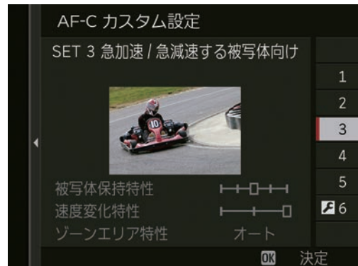
■ プリセット選択画面 「被写体保持特性」、「速度変化追従性」、「ゾーンエリア特性」の 3 要素を組み合わせた 5 パターンを搭載。
